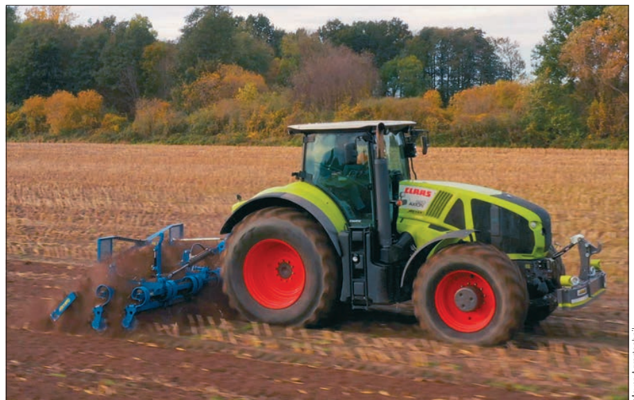
Die Messerwalze von Meyer Agrartechnik soll größere Flächenraten ermöglichen und längere Standzeiten bieten als herkömmliche Messerwalzen oder Mulcher.
